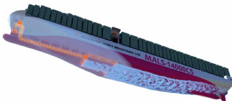
Rys. 2. System napowietrzania MALS [Mizokami i in. 2010; Kawabuchi i in. 2011; Kawakita, Sato i Okimoto 2015]
