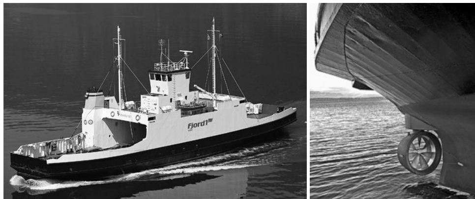
Rys. 7. Norweski prom m/f „Eiksund”, o długości 49 m i pojemności 28 samochodów, wyposażony w napęd główny w postaci pędnika wieńcowego [M/f „Eiksund”]
